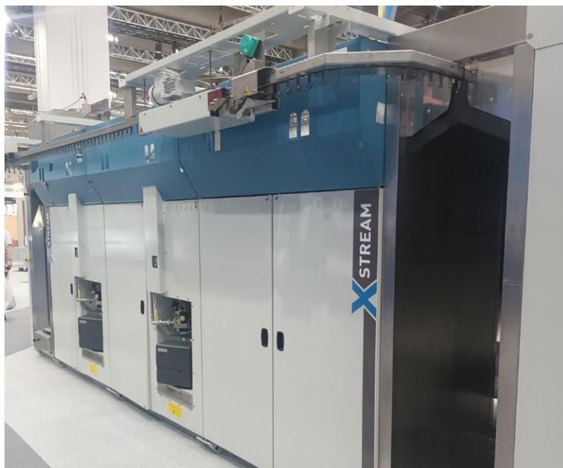
Ici le Tunnel de finition **X Stream de Kannegiesser**, construit sur la base du modèle XMT en étant doté d'un profil intérieur optimisant l'échange thermique entre le flux d'air et les vêtements, pour une économie d'énergie substantielle, selon le constructeur.
